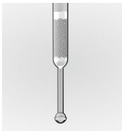
Высокотемпературная каталитическая трубка сжигания
