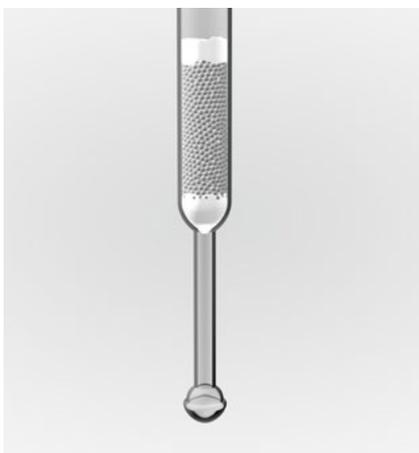
Высокотемпературная каталитическая трубка сжигания
