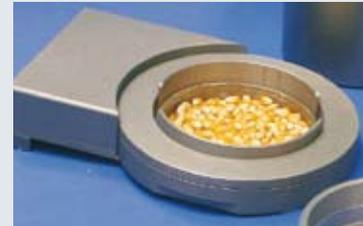
Дополнительные вращающиеся чашки различного размера могут быть установлены со смещением относительно центра для усреднения неомогенности образца
